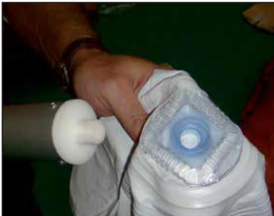
Clipser le haut du ballon (à l'intérieur du fourreau) sur l'embout blanc du mât **toujours avec précaution** sans coincer le PVC du fourreau
